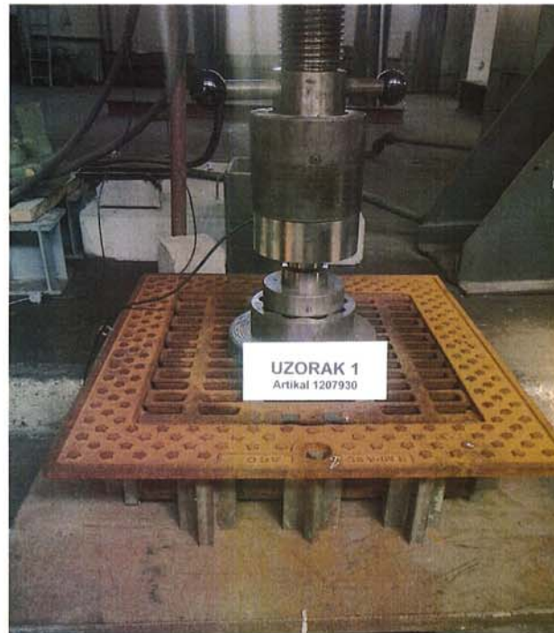
Fotografija br. 1 - Dispozicija ispitivanja zaostalih deformacija i nosivosti
