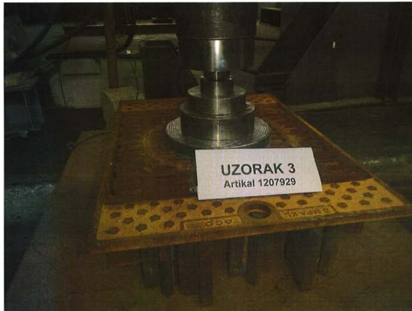
Fotografija br. 1 - Dispozicija ispitivanja zaostalih deformacija i nosivosti
