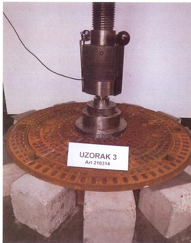
Fotografija br. 1 - Dispozicija ispitivanja zaostalih deformacija i nosivosti
