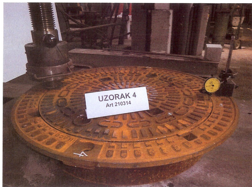
Fotografija br. 2 - Dispozicija ispitivanja odizanja poklopca u odnosu na ram
