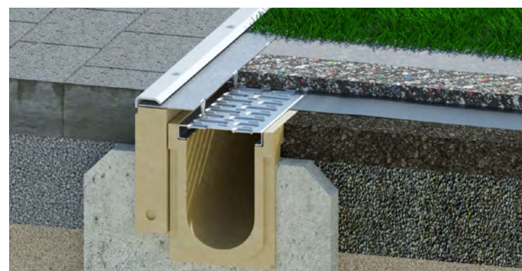
Beispiel einer Unterflurentwässerung von polgefültem Kunstrasen auf Dränageplatten
