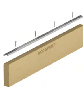
Einfassungsbord für Kunstrasen zur Fixierung mittels Klemmschiene
