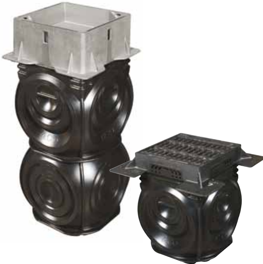
ACO Q-Slot D400 upušten poklopac sa ramom od pocinkovanog čelika
