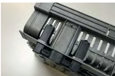
Nakon što je element za podešavanje postavljen, kanalicu pritisnuti odozgo dok ne dođe do zvučnog klika, nakon klika element za podešavanje je postavljen pravilno i potpuno funkcionalan.
