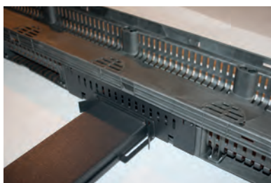
Preklopite pera ka spolja za fiksiranje.
