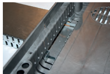
Jezičke od veznog kanala saviti ka unutra.
