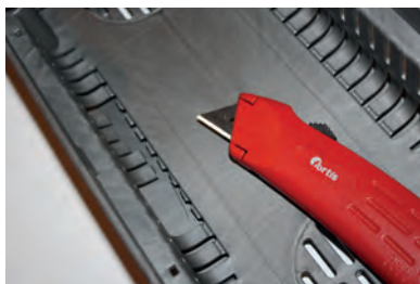
Obeleženi deo, preseći skalpelom, presečena rebra gurnuti ka spolja.
