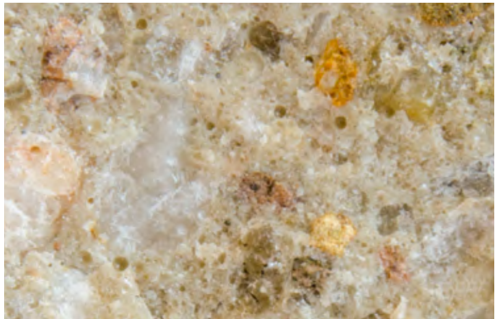
Polymerbeton im Werkstoffschnitt
