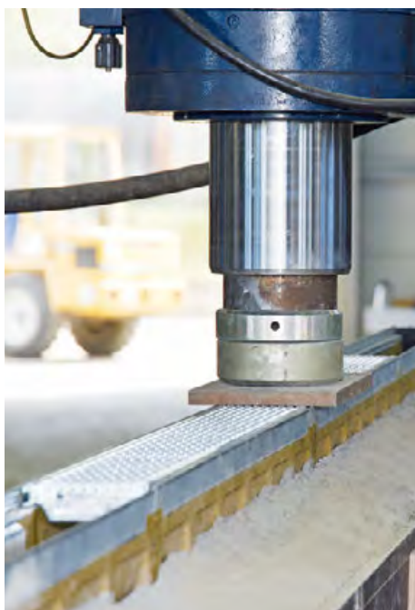
Prüfung der Dichtheit nach Langzeitsimulation
